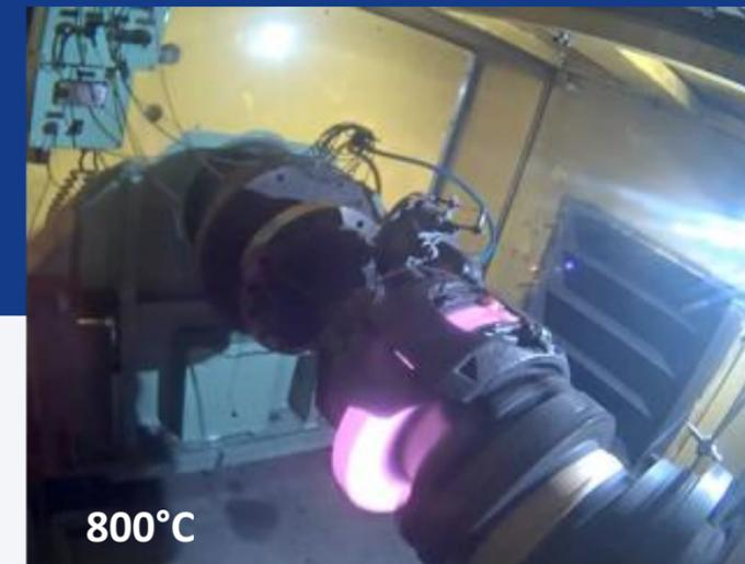
O sistema de freio à disco é desenvolvido para suportar um aquecimento controlado e para proporcionar seu rápido resfriamento através dos discos ventilados
