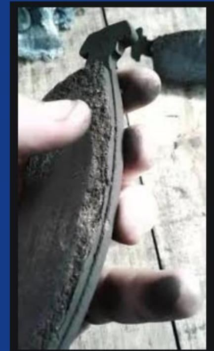
O material de fricção, por ser composto por uma resina termofixa e outros componentes também orgânicos, tem seu desgaste incrementado na medida em que a temperatura do sistema de freio se aproxima ou ultrapassa a temperatura de degradação destes componentes. Assim, quanto mais alta a temperatura maior será o desgaste.
